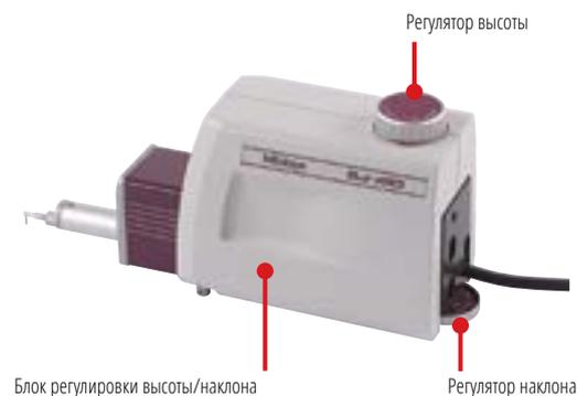
Блок регулировки высоты/наклона
