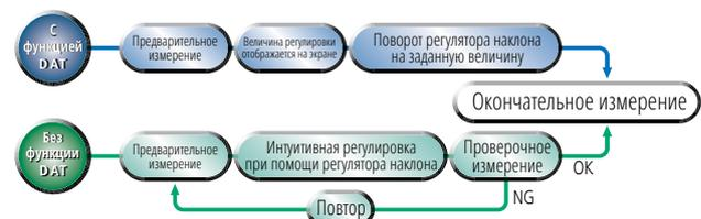
Когда прибор серии SJ-410 установлен на гранитном основании с колонной\*<sup>1</sup> для измерения, то он может быть оснащен с любым из дополнительных принадлежностей для упрощения выравнивания: выравнивающий стол\*<sup>1</sup>, 3-осевой выравнивающий стол\*<sup>1</sup> или блок регулировки наклона\*<sup>1</sup>.
