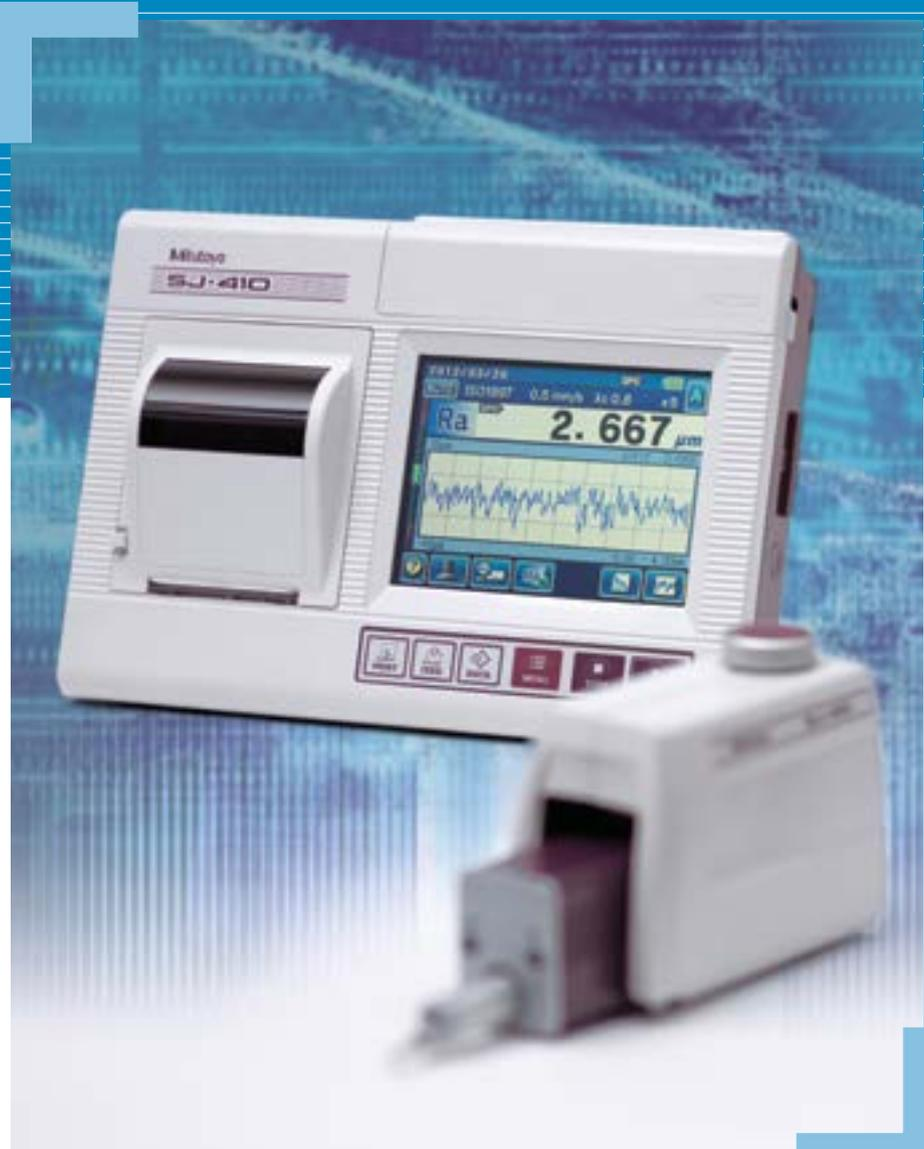
**Портативный прибор для измерения шероховатости. Богатый выбор опций обеспечивает простые, плавные и точные измерения.**
