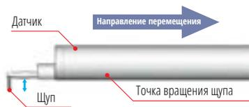
Пример измерения ступеней: Без опоры
