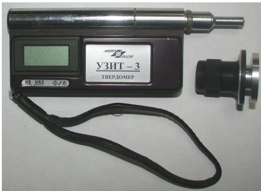
Рисунок 1 - Общий вид измерителя твердости ультразвукового УЗИТ-3
