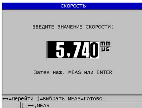
Рис. 5-7 Ввод известной скорости звука в материале
