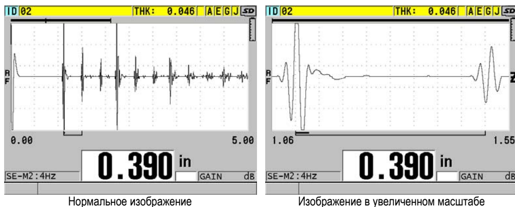
Рис. 4-9 А-скан в обычном и увеличенном масштабе в режиме 2
