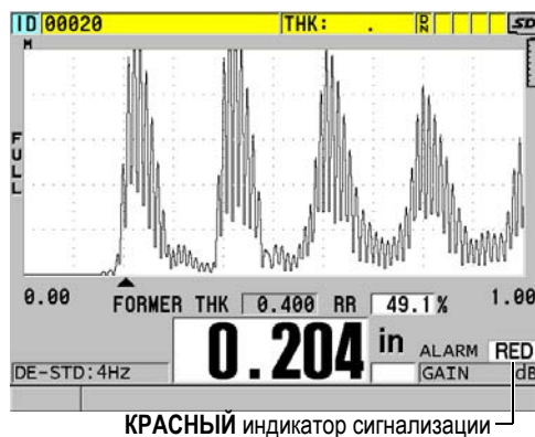
Рис. 8-6 ЖЕЛТЫЙ и КРАСНЫЙ индикаторы сигнализации
