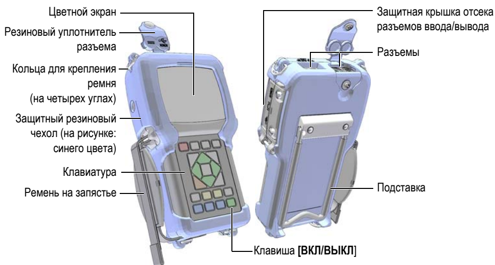
Рис. 1-2 Компоненты приборной части 38DL PLUS
