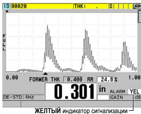
Рис. 8-6 ЖЕЛТЫЙ и КРАСНЫЙ индикаторы сигнализации
