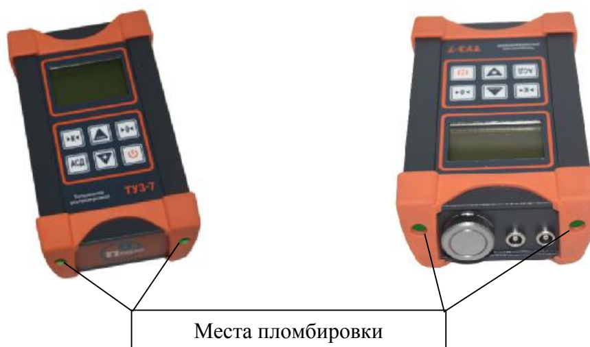
Рисунок 2 - Схема пломбировки от несанкционированного доступа
