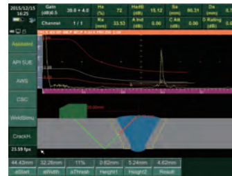
Измерение глубины залегания дефекта
