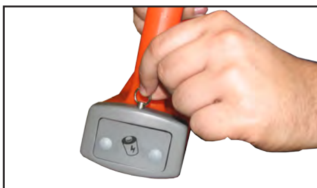
а) Выдвинуть фиксатор и освободить батарейный отсек
