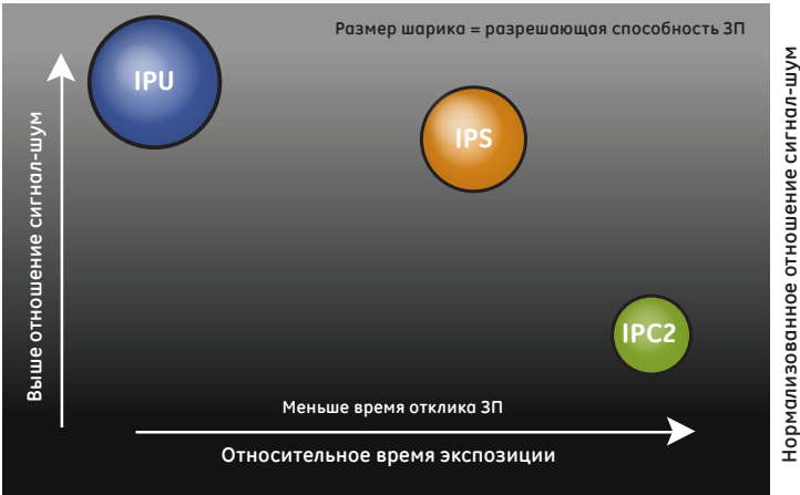
На этом графике показаны относительные различия во времени отклика, нормализованном отношении сигнал-шум и разрешающей способности рентгеновских люминесцентных запоминающих пластин GE.
