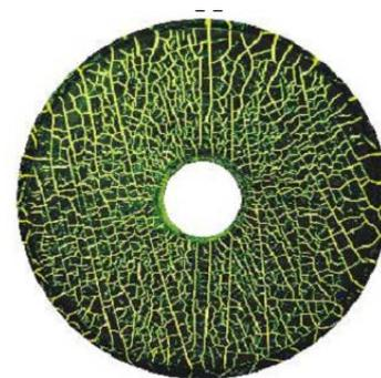
представляет собой суспензию на масляной основе, готовую к использованию, которая идеально подходит для проведения инспекции прямо на месте. Позволяет обнаружить даже самые мелкие трещины.
