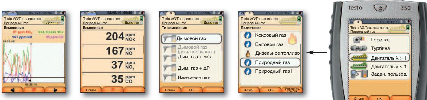
5. Документирование ← 4. Измерение ← 3. Выбор типа измерения ← 2. Выбор топлива ← 1. Выбор области применения
