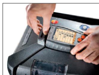
Управляющий модуль просто "зашелкивается" в блок анализатора
