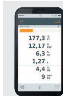
Управление измерительным прибором, а также отображение измеренных значений осуществляется по Bluetooth с Вашего смартфона или планшета с помощью мобильного приложения для testo 330i, независимо от места замера. Помимо этого, Вы можете создавать отчеты, добавлять к ним фотографии и комментарии и отправлять их по e-mail. Для мобильных устройств с модулем Bluetooth 4.0 и выше на базе не ниже версий iOS 7.1 и Android 4.3.
