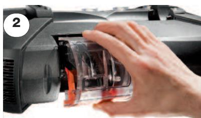
**2. Блок анализатора** в ударопрочном корпусе обеспечивает защиту сенсоров, насосов и внутренней электроники.
