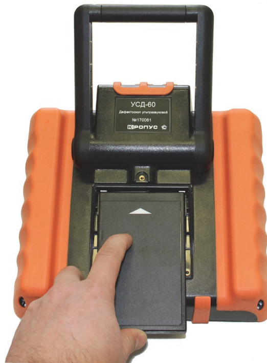
Рис.1-4 Установка нового аккумулятора
