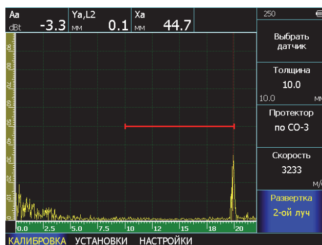
Рис.3-18 Результат автоматической калибровки ПЭП AN5070 на образце СОП-10-2х1 из стали 20
