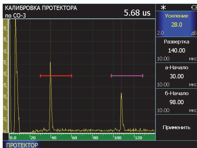
Рис.3-13 Калибровка наклонного преобразователя по образцу СО-3
