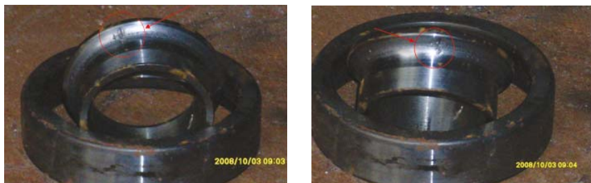
Рис. 2. Повреждения на внутренних кольцах подшипников качения
