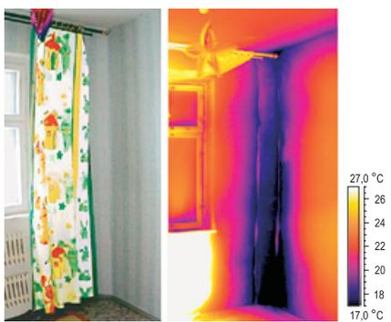
Рис. 1. Тепловизор: информация о дефектах при тепловизионной съемке внешних стен в помещениях: вни-зу углового стыка температура на 10 °С ниже температуры воздуха
