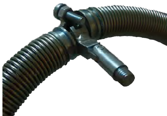
Рис. 22. Подготовленный к проведению контроля пружинный электрод
