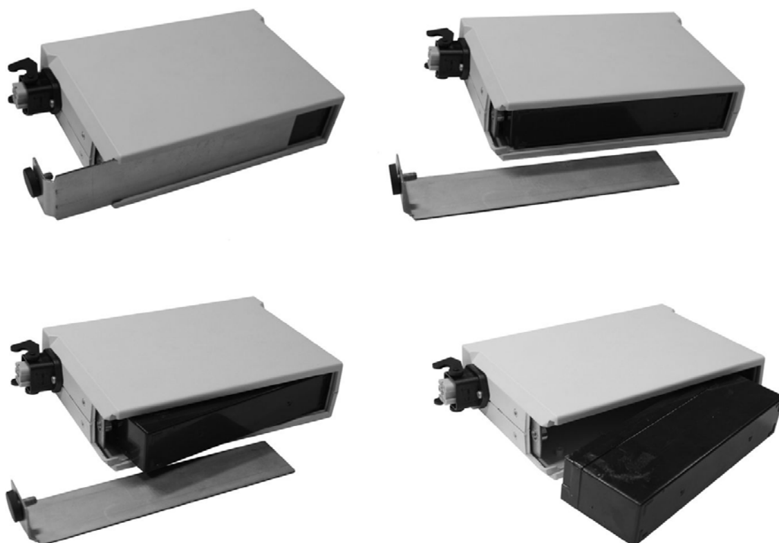
Рис. 30. Последовательность действий при замене аккумулятора
