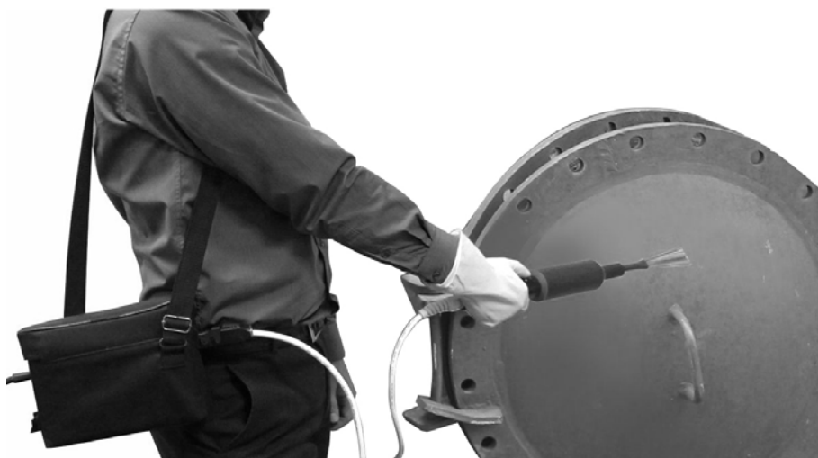
Рис. 21. Положение прибора при проведении контроля
