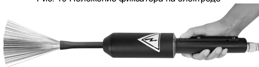
Рис. 20 Положение электрода, закрепленного в высоковольтном трансформаторе-держателе
