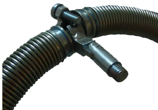
Рис. 22. Подготовленный к проведению контроля пружинный электрод
