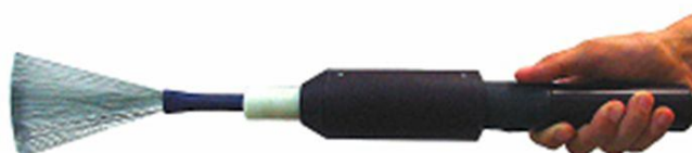
Рис. 20 Положение электрода, закрепленного в высоковольтном трансформаторе-держателе
