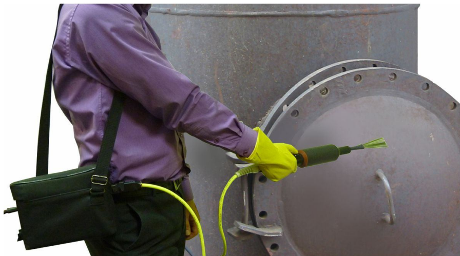
Рис. 21. Положение прибора при проведении контроля
