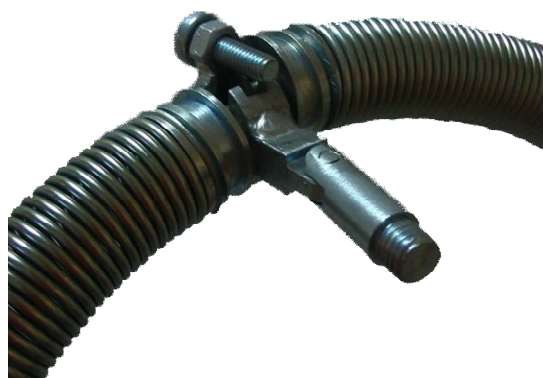
Рис. 22. Подготовленный к проведению контроля пружинный электрод
