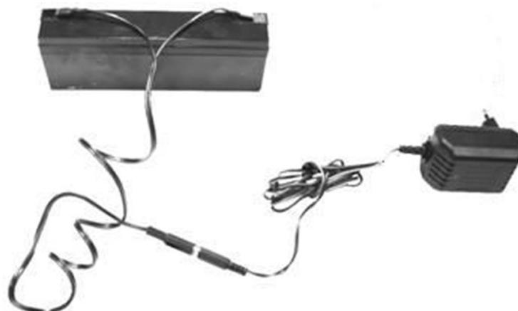
Рис. 28. Внешний заряд аккумулятора: подсоединение к переходному разъему на кабеле зарядного устройства соединительного кабеля с клеммами для подключения к аккумулятору и подсоединение клемм кабеля зарядного устройства к выводам аккумулятора
