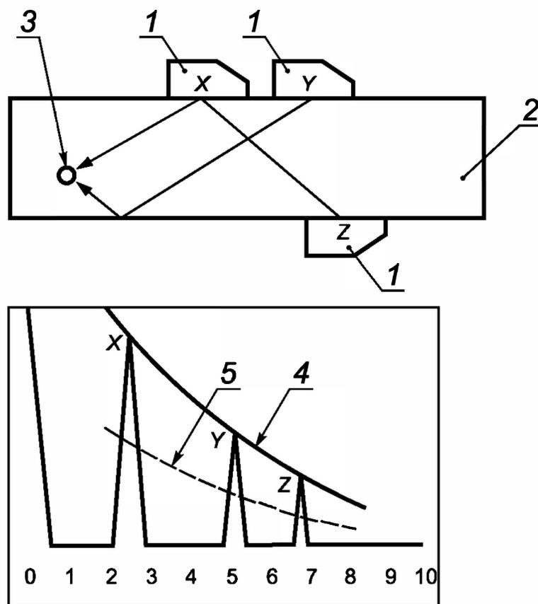
1 — наклонный преобразователь (2.5.1); 2 — контрольный образец (2.7.3); 3 — контрольный отражатель (2.7.4), боковой цилиндрический отражатель (2.7.5); 4 — кривая коррективной амплитуда-расстояние (АРК-кривая) (2.12.4); 5 — уровень 50 % АРК-кривой; X, Y, Z — положение преобразователя
