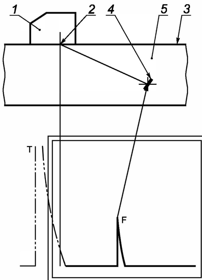
с) метод наклонного преобразователя
