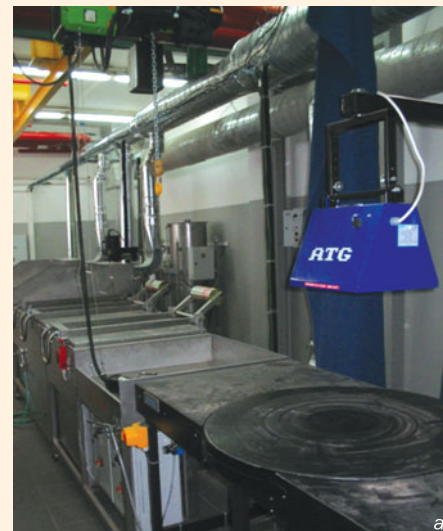
Рис. 10. Контролируемые лопатки под УФ лампы
