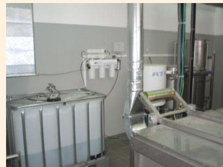
Рис. 8. Фрагмент линии, установка осмотической фильтрации промывочной воды
