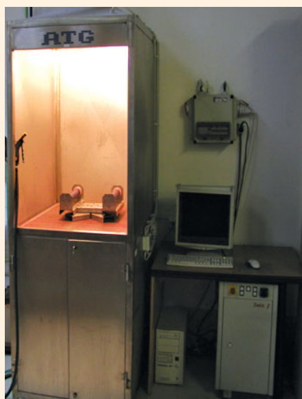
Рис. 11. Локальный участок капиллярного контроля
