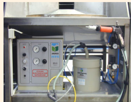
Рис. 7. Установка электростатического нанесения сухого проявителя
