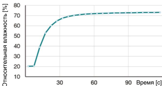
Два фактора значительно сокращают время измерения: небольшой объем воздуха измерительной манжеты и исключительно высокое быстродействие датчика.
