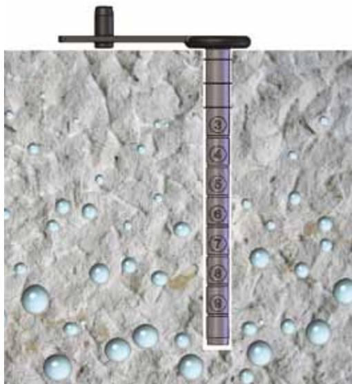
Содержание влаги в бетоне отличается от ее содержания на поверхности. Методы измерения на поверхности дают результат в лучшем случае для глубины до 20 мм и не обязательно отражают реальное положение. Поэтому прибор HugroPin использует технологию контактного измерения, при котором выявляется фактическое содержание влаги внутри бетона.
