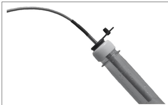
Эталон влажности обеспечивает быструю и простую проверку функциональности и калибровки прибора и контактного датчика, как рекомендовано ASTM. Благодаря насыщенному раствору соли микроклимат внутри тестовой трубки остается равен 75% RH.
