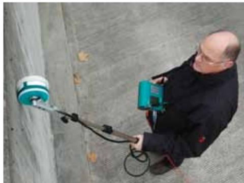
1-роликовый электрод для быстрого сканирования больших площадей
