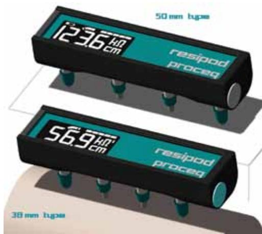
Более широкое расстояние между зондами обеспечивает более согласованное считывание при измерении такого неоднородного материала, как бетон. Однако, при слишком большом расстоянии есть риск того, что на измерение повлияет стальная арматура. Промышленный стандарт 50 мм для расстояния между датчиками уже давно считается хорошим компромиссным вариантом.
