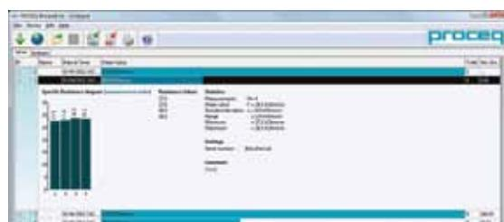
Собранные значения измерений можно затем проанализировать с помощью программного инструмента ResipodLink.
